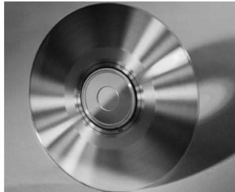
Il *compact disc* ha un diametro di 120 mm con un foro centrale di 15 mm ed uno spessore di 1.2 mm. Le informazioni vengono memorizzate fisicamente su di un disco sotto forma di piccoli forellini, chiamati in inglese "**pit**", mentre le zone piatte fra un foro ed un altro sono dette "**land**". I pit e i land sono disposti secondo una traccia a spirale, larga 0.6 $\mu$  (milionesimi di metro), che viene letta verso l'esterno partendo dal centro del disco.
